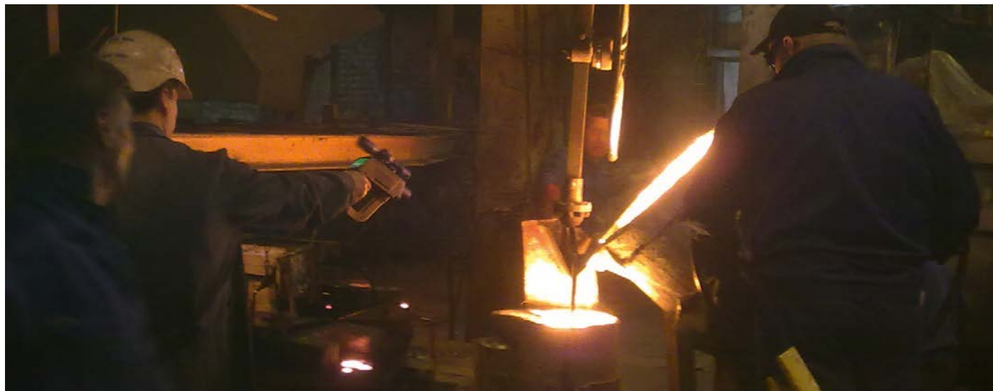
使用P20 05M对铸造厂中的熔体进行详细的红外温度测量。
