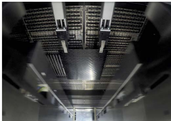
CT LT - 热成型机中带层流空气净化装置的测量头
