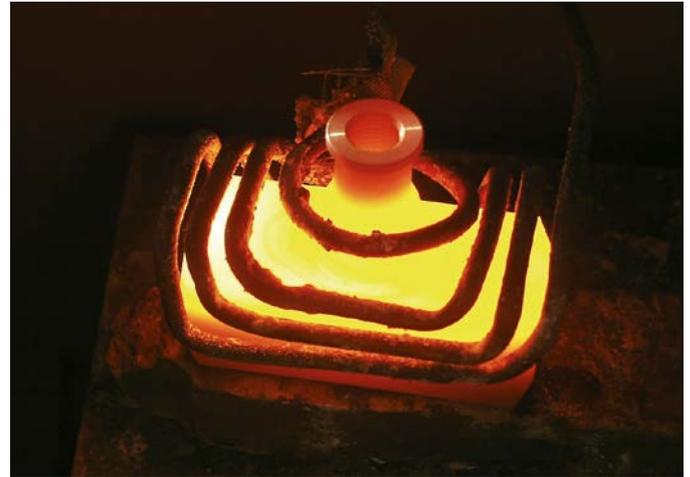
optris® CTlaser 1M/2M/3M utilisés pour le contrôle de la trempe
