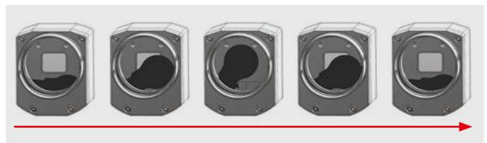
*Pour permettre de corriger l'offset, des bolomètres, le champ de visée complet de la caméra est brièvement obturé*
